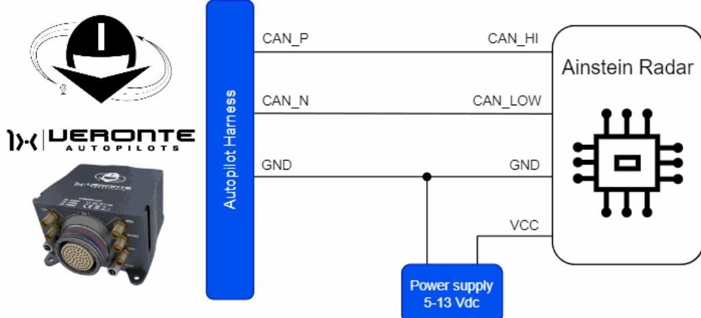
**Ainstein CAN Radar - Autopilot 1x wiring diagram**
