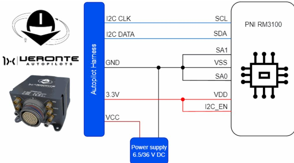
**PNI RM3100-CB - Autopilot 1x wiring diagram**
