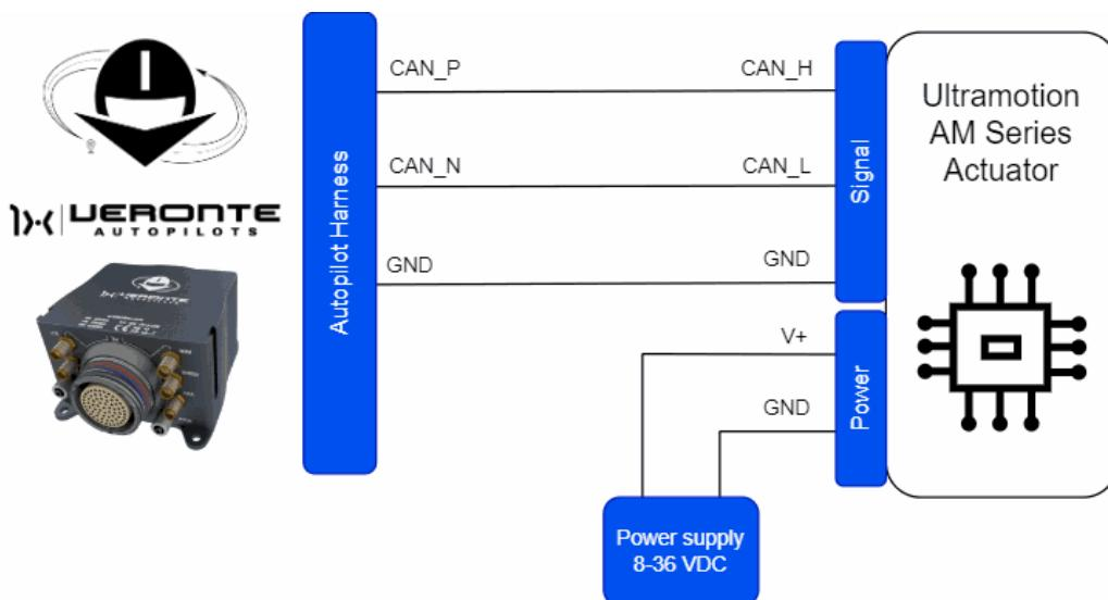
**Ultra Motion - Autopilot 1x wiring diagram**
