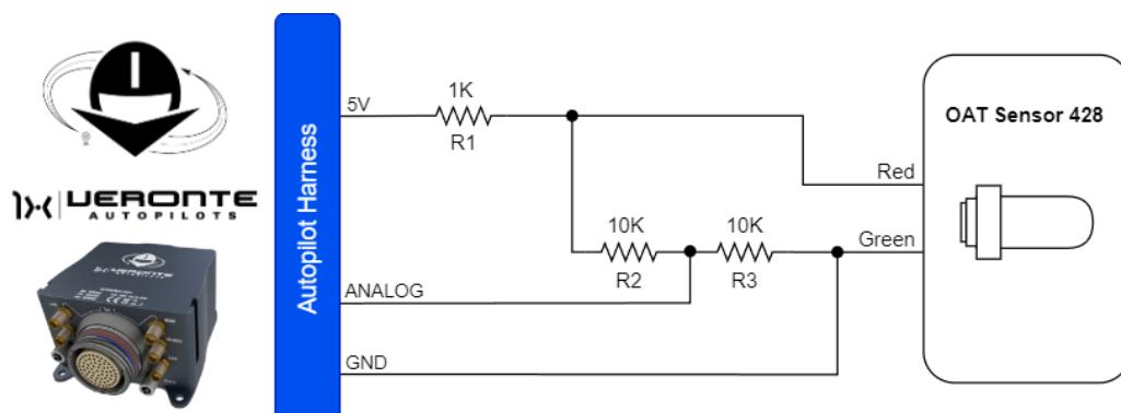
**OAT sensor - Autopilot 1x wiring diagram**
